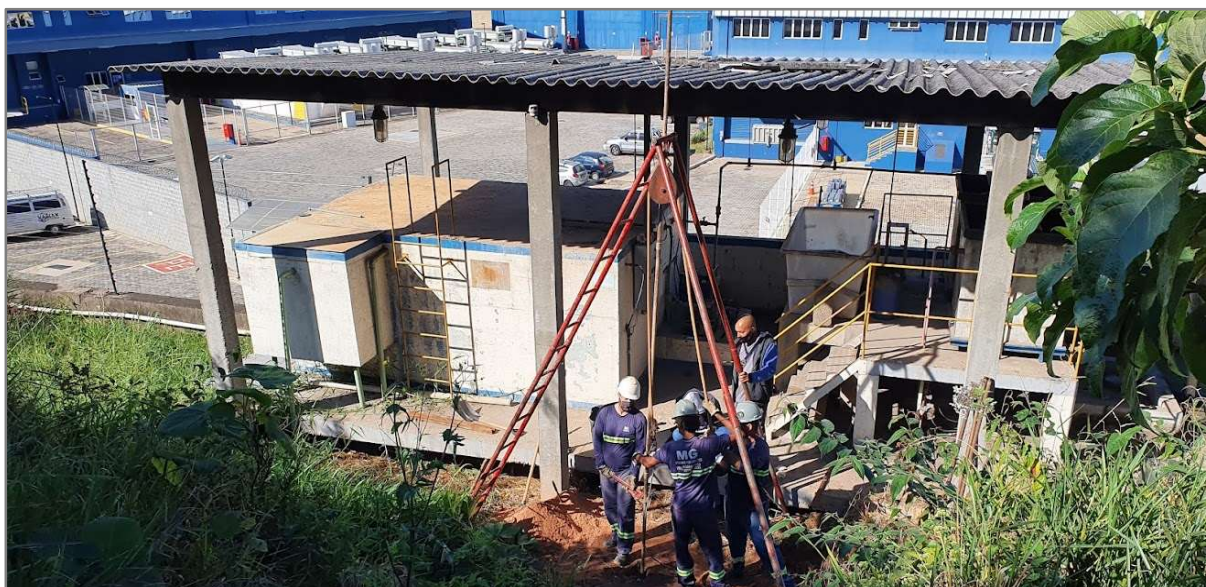
FIGURA 3 – Sondagem do tipo manual com o uso de tripé e trado manual
